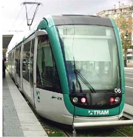
**Ilustración 6:** Tranvía eléctrico, la electricidad llega al vehículo mediante cables en la parte superior del mismo. (Fuente: <http://manoverde.scoom.com/2009/12/10/el-tranvia-que-unira-a-la-bahia-nos-gustaria-que-uniera-aun-mas/>)
