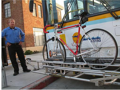
**Ilustración 13:** Estante para bicicletas en la parte frontal de un autobús.
