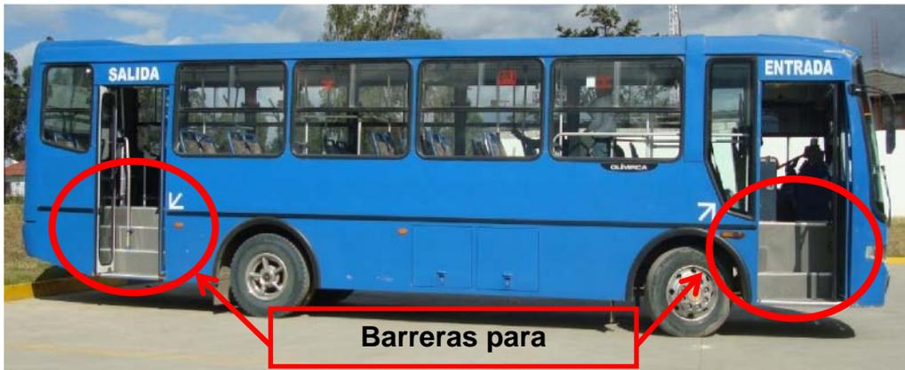
**Ilustración 16:** Peldaños impiden el ingreso de sillas de ruedas al interior de los vehículos.
