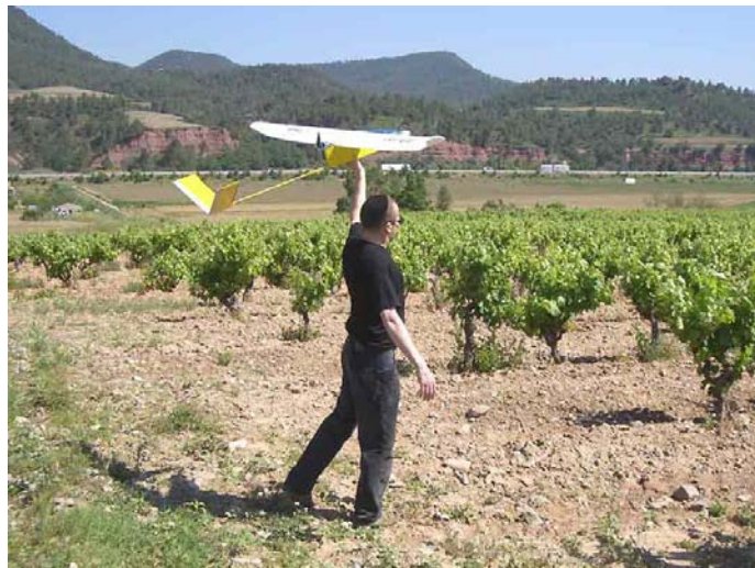
Figura 1-14: Avión no tripulado con una envergadura de 1.8 mts y peso de 2 kg (puede llevar hasta 500 gr de carga útil) Son idóneos para el seguimiento de grandes infraestructuras, actualización cartográfica para administraciones públicas, captura de imágenes georreferenciadas
