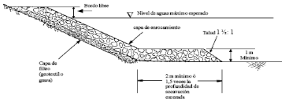
b. Detalles de la capa de enrocamiento de protección colocado en el fondo del cauce del arroyo.
