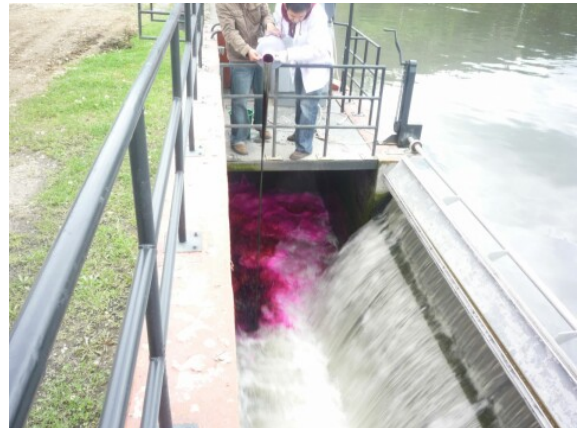
(b) Colocación de la rodamina en la laguna
