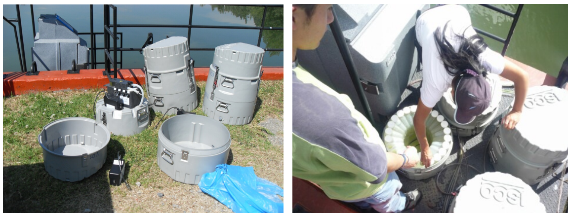
(a) Muestreadores automáticos ISCO usados en las pruebas (b) Botellas en las que se colocan las muestras
