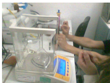
(g) Balanza de precisión \pm 0.0001 gr
