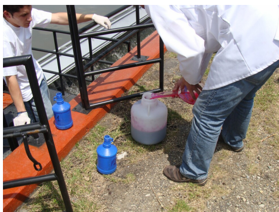
Figura 3.13: Mezcla del trazador con agua de la laguna para homogenizar la temperatura
