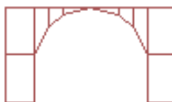
Figura 4.27. Sección discretizada de los arcos longitudinales de cimentación (Arco en los ejes longitudinales 3 y 4, ente los ejes transversales A y B, ver Fotografías 3.9. y 3.15. )
