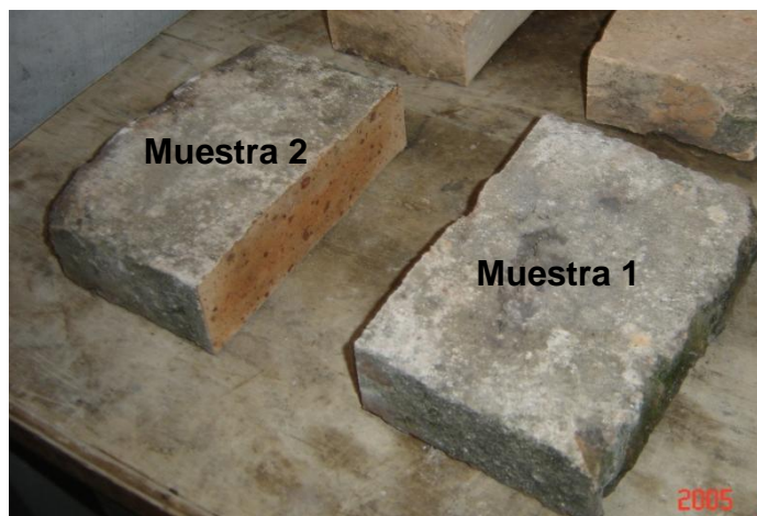
Foto 3.29. Muestras de ladrillos tomados de la Catedral Nueva de Cuenca
