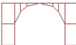
Figura 4.29. Sección discretizada de los arcos longitudinales de cimentación (Arco en los ejes longitudinales 3 y 4, ente los ejes transversales D y E, ver Fotografías 3.12. Y 3.18. )
