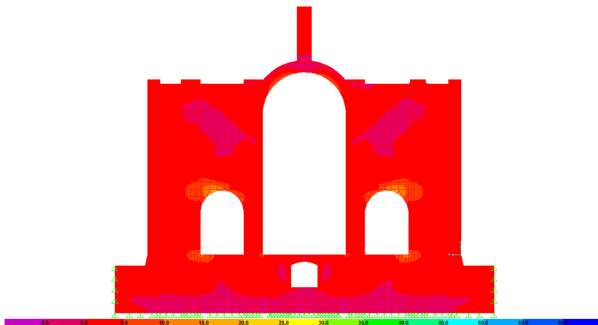
Figura 6.91. Esfuerzos S22-Max (Comb4) en el Pórtico Transversal D.
