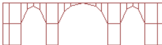
Figura 4.30. Sección discretizada de los arcos longitudinales de cimentación (Arco en los ejes longitudinales 3 y 4, ente los ejes transversales E y F, ver Fotografías 3.13. y 3.19. )
