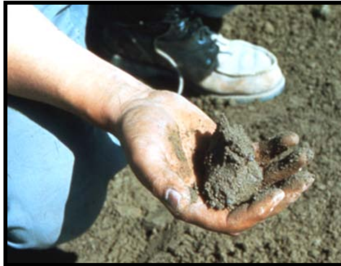
Figura 7: Esquema de la consistencia de un hormigón compactado con rodillo [11].
