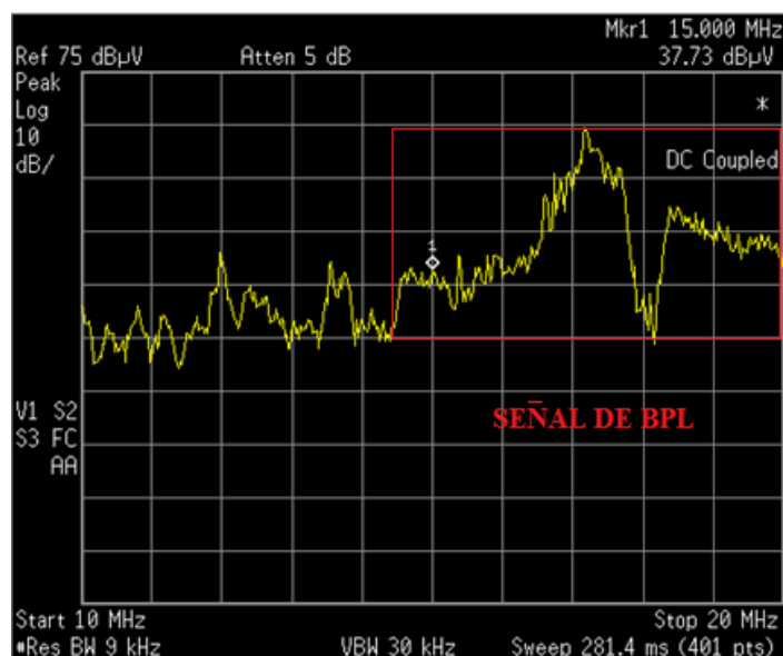
Figura 4.23.- Grafica de la señal BPL en un rango de 10MHz a 20MHz.
