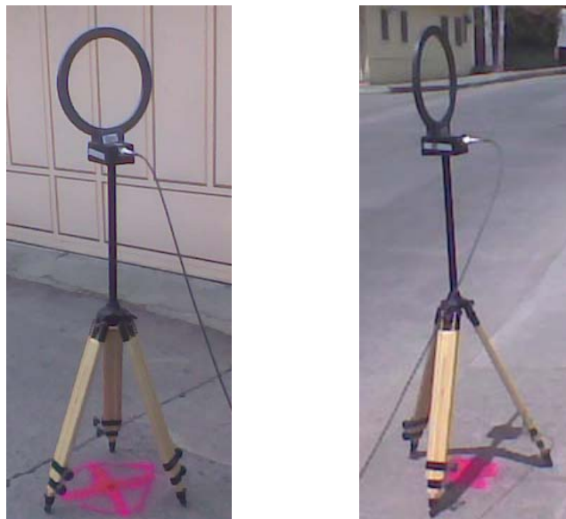
Figura 4.11.- Antena tipo Loop en los puntos de trabajo.
