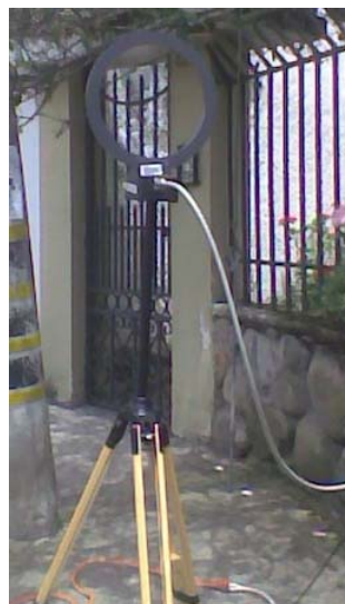
Figura 4.14.- Antena tipo Loop en las pruebas con BPL funcionando.
