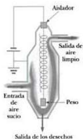
Figura 1.2. Precipitador electrostático (7).
