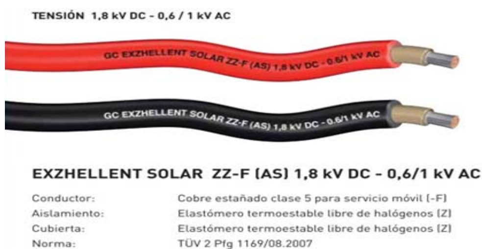
Figura 2.41 Tipo de conductores utilizados en una instalación fotovoltaica.
