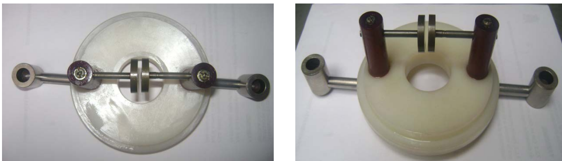
Fig.4.1 Electrodos de caras planas usadas en ensayo de ruptura para aceite dieléctrico
