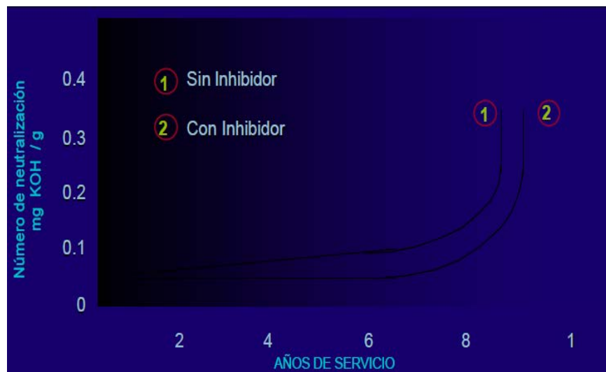
Fig. 3.1. Curva de oxidación de aceite dieléctrico.
