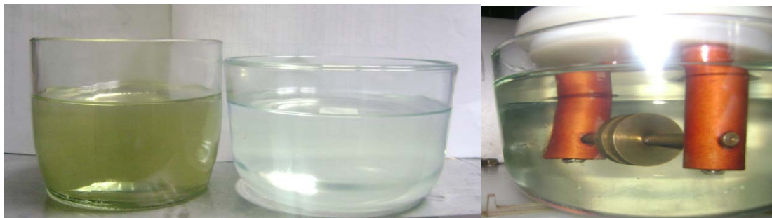
Fig. 4.2 Envase de prueba llenado con líquido aislante usado y nuevo.
