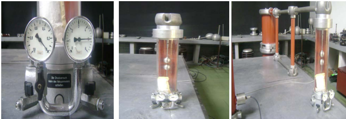
Fig.4.4 Cámara de presión y circuito de conexión para pruebas de rigidez dieléctrica en gases aislantes.
