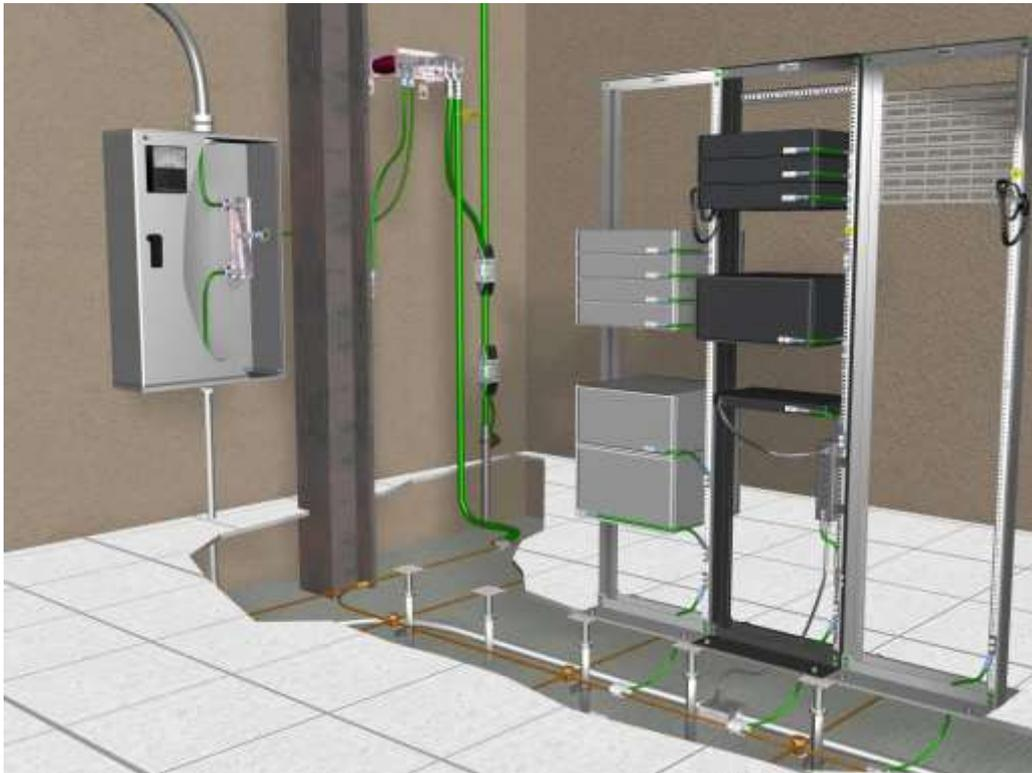
**Figura 1 - 9 Instalación de puesta a tierra de un Centro de Datos**
