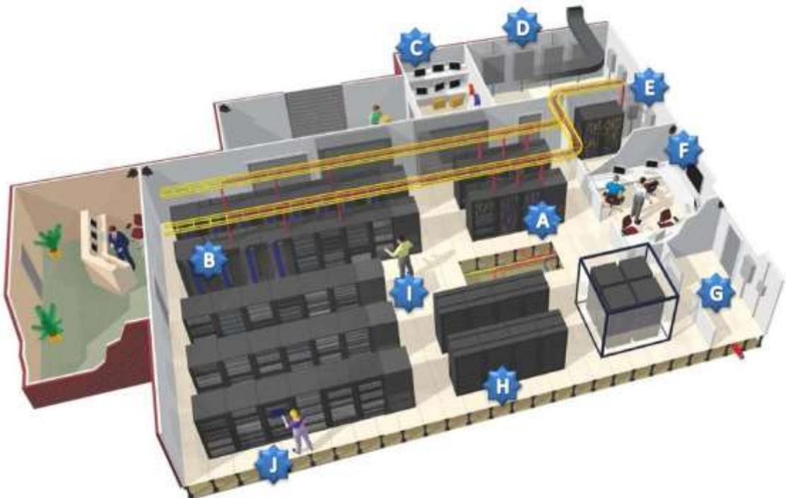
**Figura 1 - 5 Ejemplo de distribución de áreas en un Centro de Datos**
