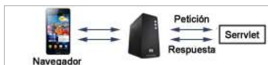
Figura 4-1: Funcionamiento de un servlet
