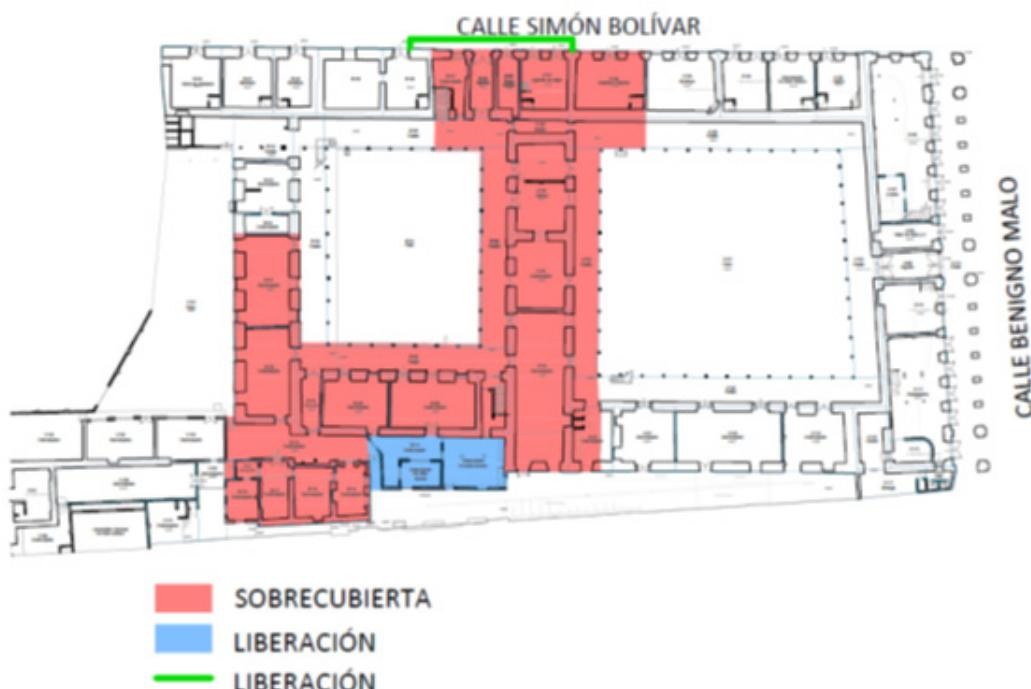
Imagen 5-14: Plano de la zonificación del área que comprenderá la sobrecubierta provisional para el Antiguo Seminario Mayor.
