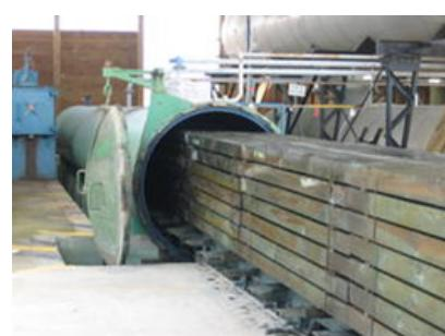
Imagen 4-24: Impregnación con autoclave en madera
