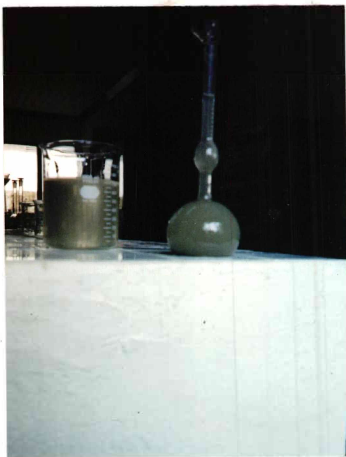
ENSAYO PARA ENCONTRAR LA DENSIDAD DE LAS PUZOLANAS (BALON DE LE CHETELIER).
