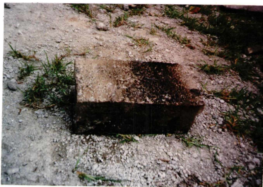
BLOQUES DESPUES DE HABER SIDO SOMETIDO AL FUEGO
