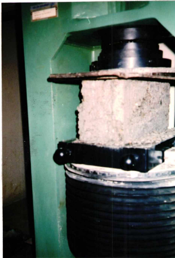
ENSAYO DE COMPRESION EN BLOQUES HUECOS Y MACIZOS.
