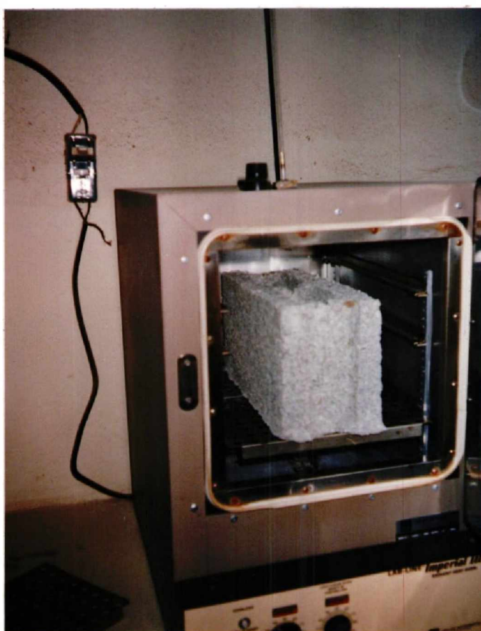
ENSAYO PARA LA DETERMINACION DEL CONTENIDO DE HUMEDAD Y ABSORCION DE AGUA. EN BLOQUES HUECOS.
