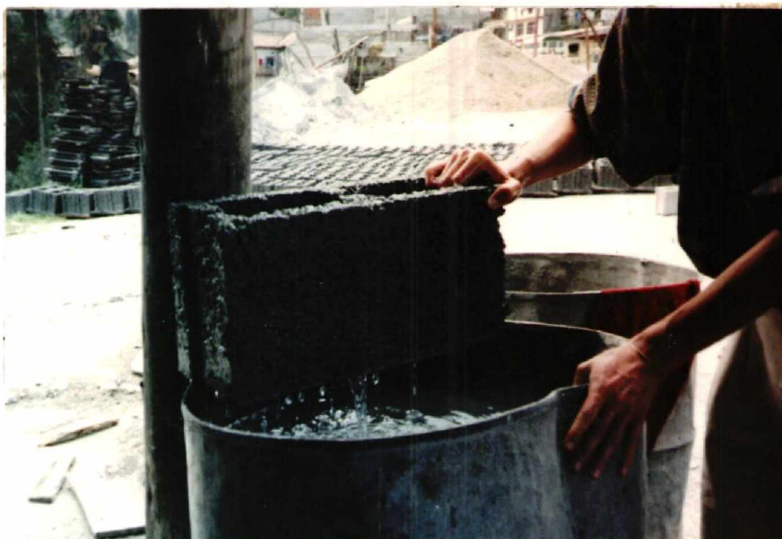
BLOQUES SUMERGIDOS EN AGUA DURANTE 64 DIAS PARA ANALISIS DE RESISTENCIA A LAS CONDICIONES CLIMATICAS.
