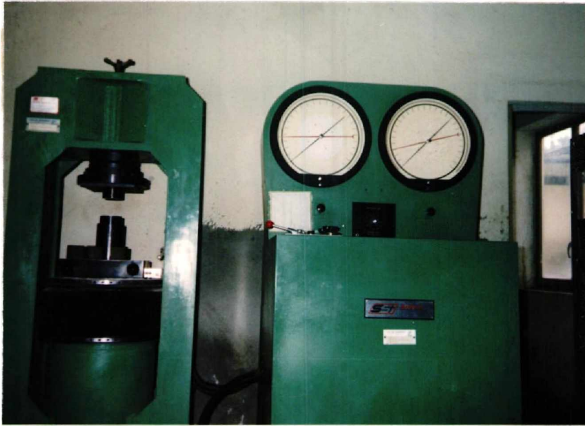
MAQUINA DE COMPRESION (PROVISTA DE UN PLATO CON ROTULA DE SEGMENTO ESFERICO).
