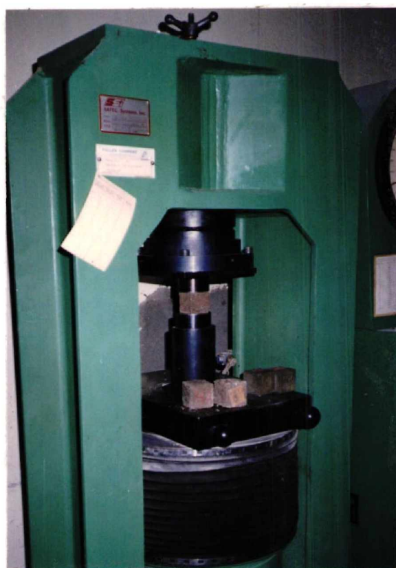
ENSAYO PARA LA DETERMINACION DE LA ACTIVIDAD PUZOLANICA Y DETERMINACION DE LA RESISTENCIA A COMPRESION.
