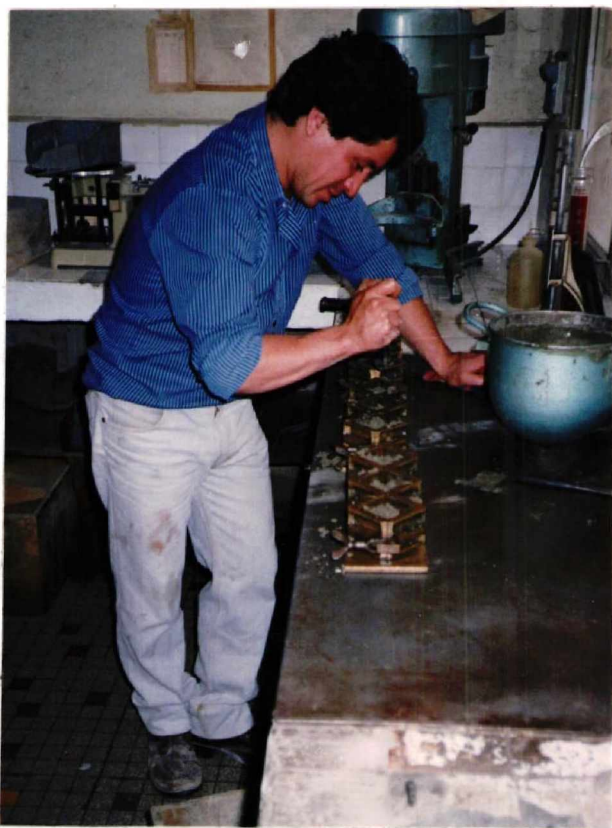
ENSAYO PARA LA DETERMINACION DE LA ACTIVIDAD PUZOLANICA.-ELABORACION Y CURADO DE PROBETAS (CAMARA HUMEDA).
