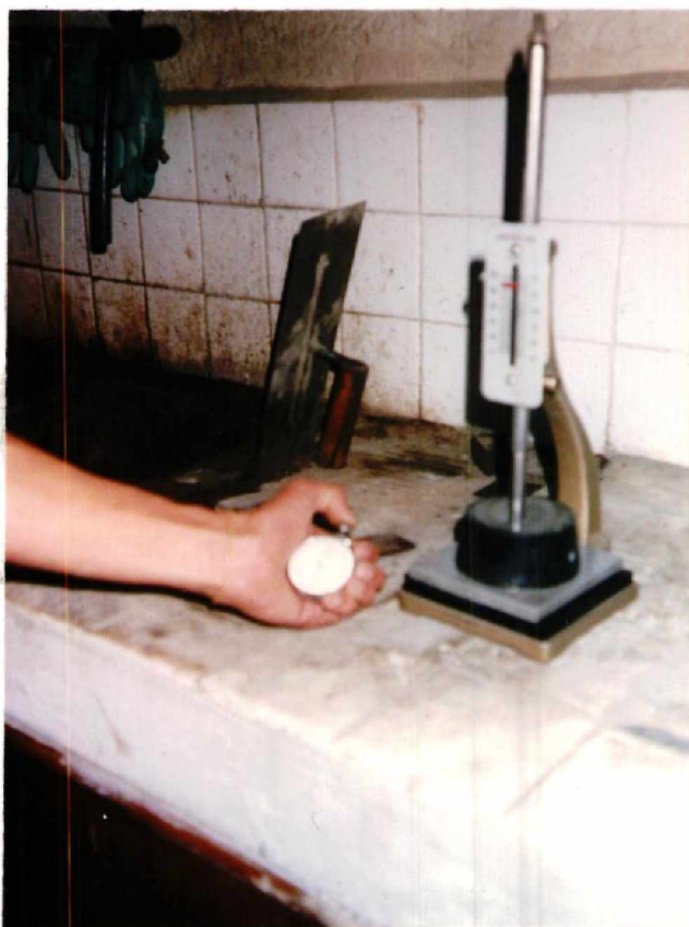
ENSAYO PARA LA DETERMINACION DE LA CONSISTENCIA NORMAL DE PASTA Y TIEMPO DE FRAGUADO.
