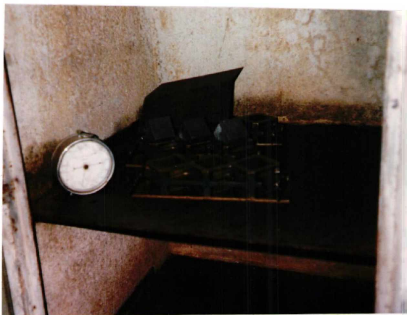
ENSAYO PARA LA DETERMINACION DE LA ACTIVIDAD PUZOLANICA.-ELABORACION Y CURADO DE PROBETAS (CAMARA HUMEDA).
