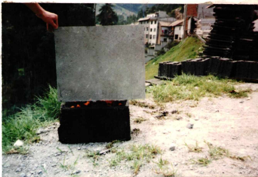
PARED DE BLOQUES SOMETIDO DIRECTAMENTE A LA ACCION DEL FUEGO
