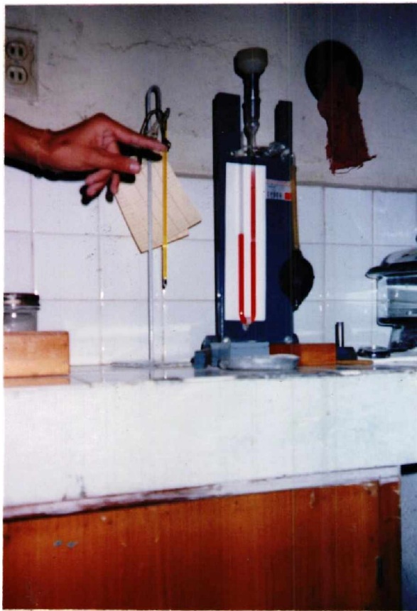
ENSAYO PARA LA DETERMINACION DE LA SUPERFICIE ESPECIFICA Y DETERMINACION DE LA GRANULOMETRIA.
