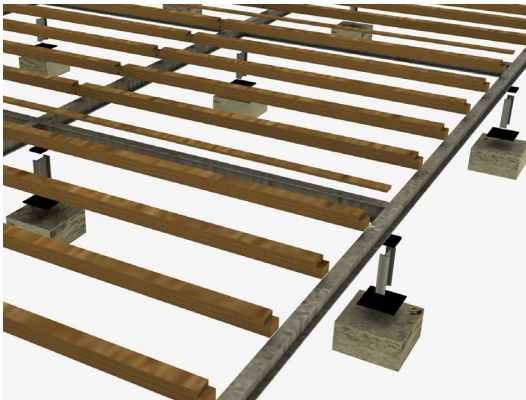
piezas que conforman el piso, separadas
