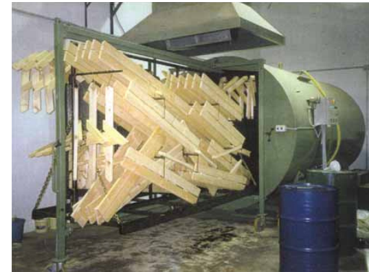
tratamientos en profundidad, por autoclave. fuente www.rincondelvago.com
