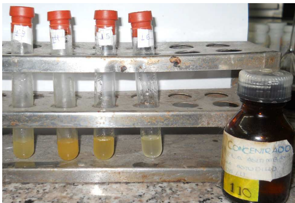
Fig. 3 J. Astudillo. Test de Kreiss . Mezcla de ácido clorhídrico con las muestras de aceites utilizadas en la elaboración de papas fritas, recolectadas en las instituciones educativas y sus inmediaciones. Cuenca 2013.
