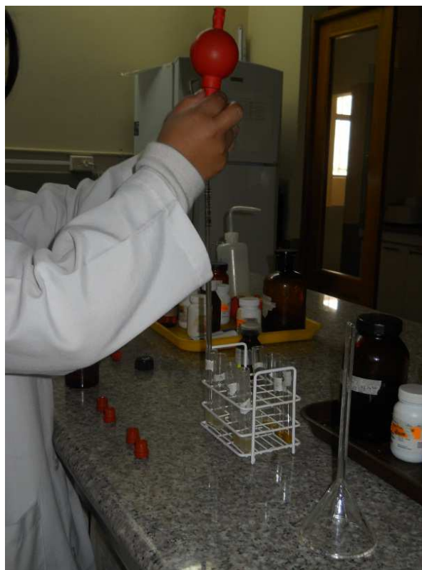
Fig. 2 J. Astudillo. Test de Kreiss . Colocación de ácido clorhídrico en las muestras de aceites utilizadas en la elaboración de papas fritas, recolectadas en las instituciones educativas y sus inmediaciones. Cuenca 2013.
