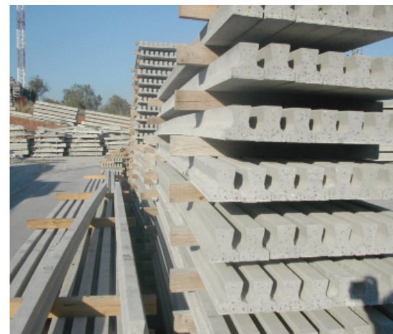
Imagen 81: Vigas Hormigón postensado
