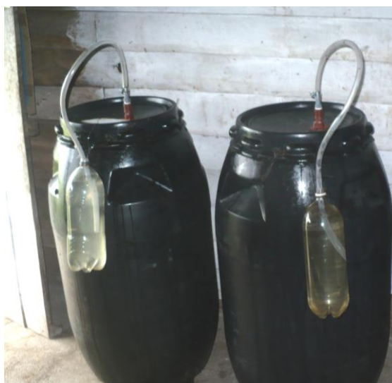
Foto 10: Sello herméticamente de los tanques
