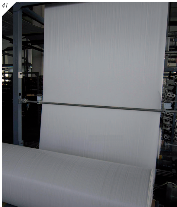
41. Sacos de polipropileno, en fabricación 42. Embutido del material en los Sacos continuos
