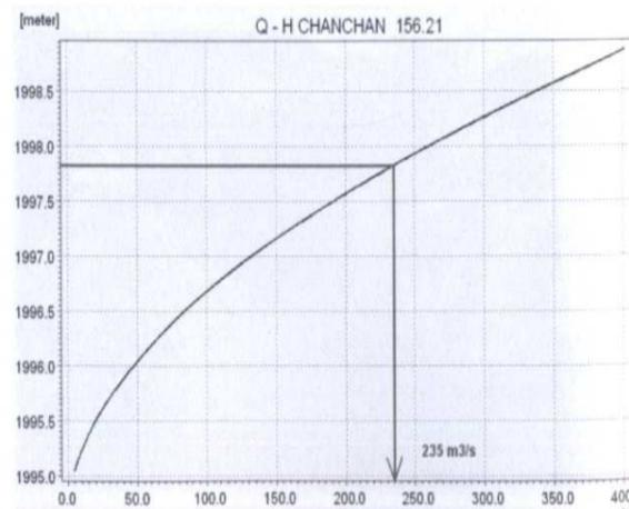
Figura 2. Curva de descarga en el Río Chanchán y lectura del valor de caudal para la altura correspondiente.
