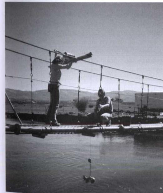
Figura 4. Captador de sedimentos en suspensión integrador en profundidad.
