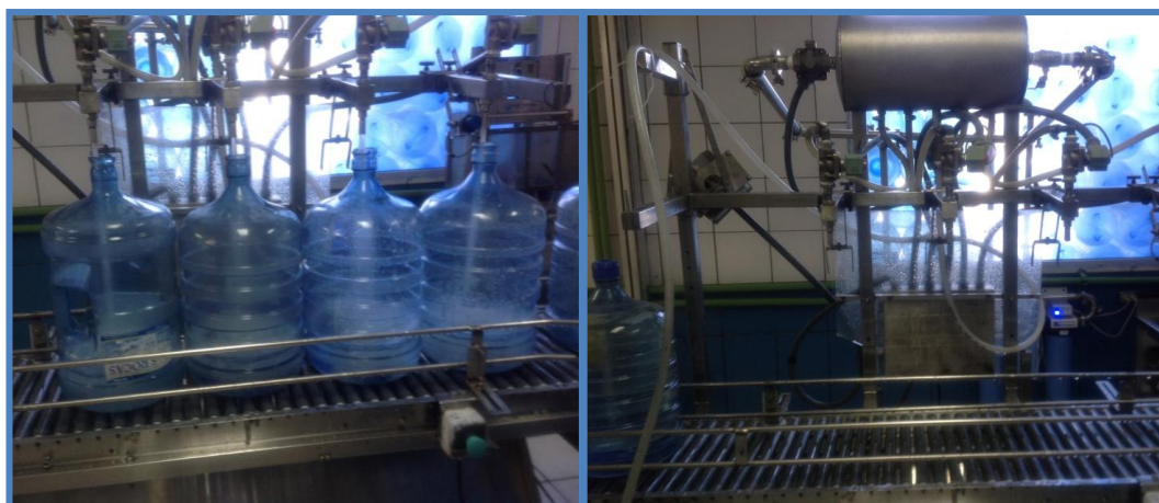
Figura 14. Maquina llenadora de bidones en CBC. Proceso de llenado (izq) y cierre hermético (der).
