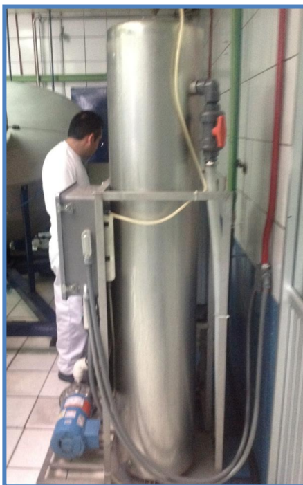
Figura 11. Equipo de ozonización en Cuenca Bottling Company (CBC).
