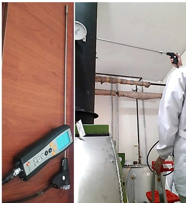
Figura 25. Medición de los gases de combustión. [Elaboración propia].
