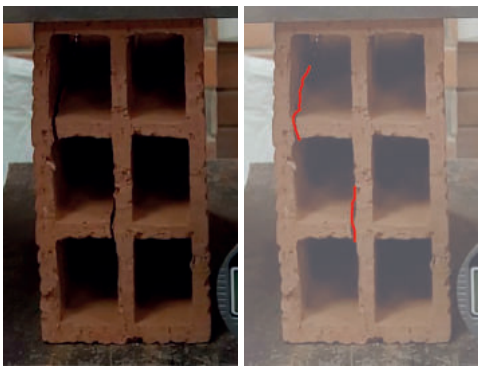
Figura 2.24. Falla por separación de paredes internas en unidades de ladrillo 4A.
