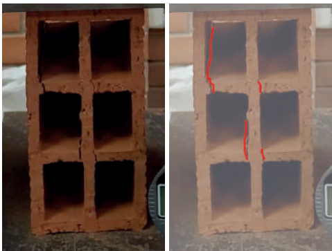
Figura 2.21. Falla por separación de paredes internas en unidad de ladrillo 3B.
