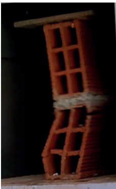
Figura 2.54. Falla por flexión en murete 4.
