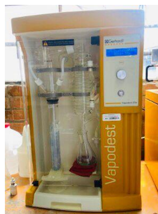
4. Equipo Gerhardt Vapodest 20 en operación durante el proceso de destilación para determinación de nitrógeno.
