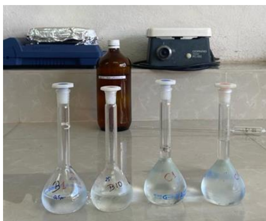
3. Balones de aforo con soluciones preparadas según el Método de Kjeldahl.
