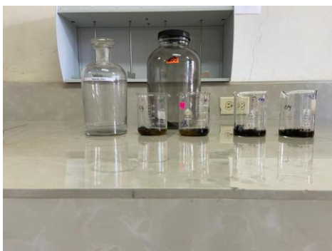
1. Fibras tratadas sumergidas en la solución de \text{NaHCO}_3
