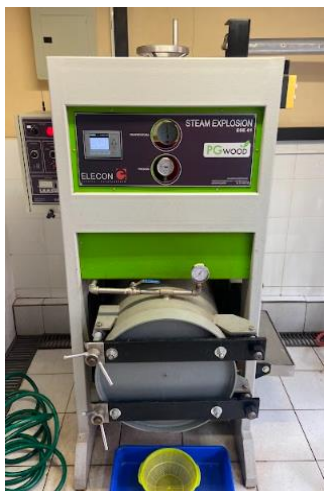
Figura 9. Equipo de explosión con vapor.
