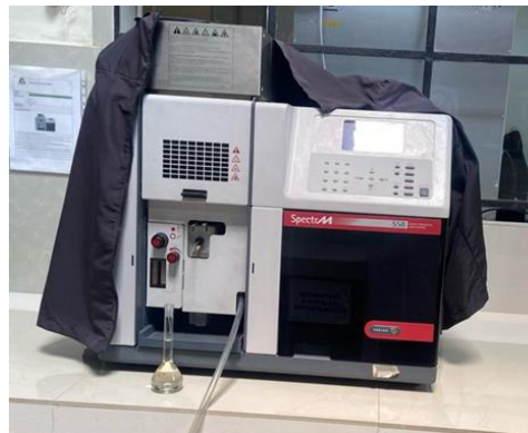
4. Determinación de potasio mediante espectrofotómetro de absorción atómica.
