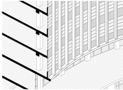
**Detalle 02.** Paramentos verticales de concreto de 15x60 cm con muro cortina de ventanas oscilantes de carpintería metálica y un panel fijo de chapa metálica acanalado reviste un muro bajo de h:1.00 m.
