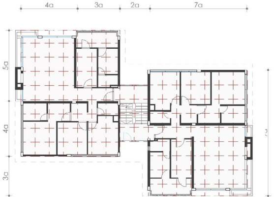
Fig.186: Relación estructura y modulación
