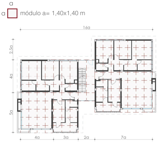
Fig.163: Relación entre sistema portante y modulación
