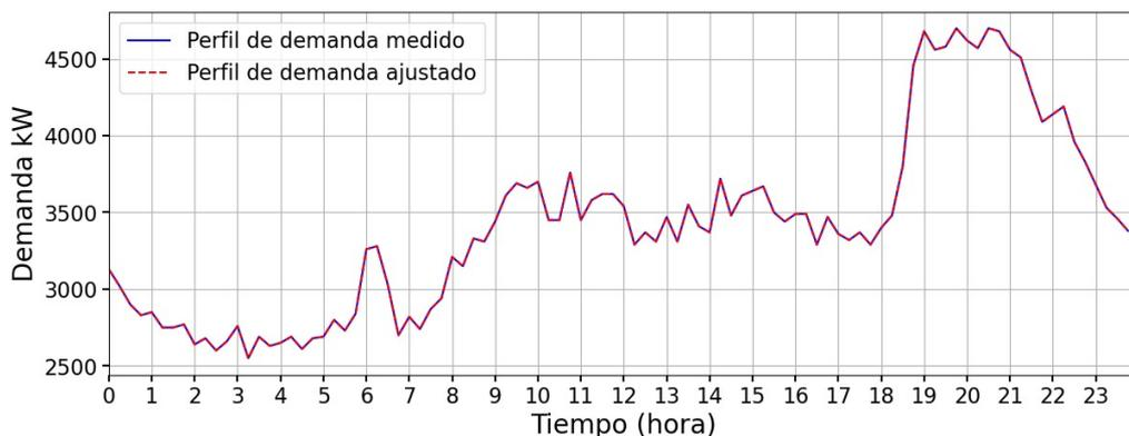
Figura 4.3: Perfil de Demanda medido y Perfil de Demanda ajustado del Alimentador 0204. Fuente: Elaboración Propia.
