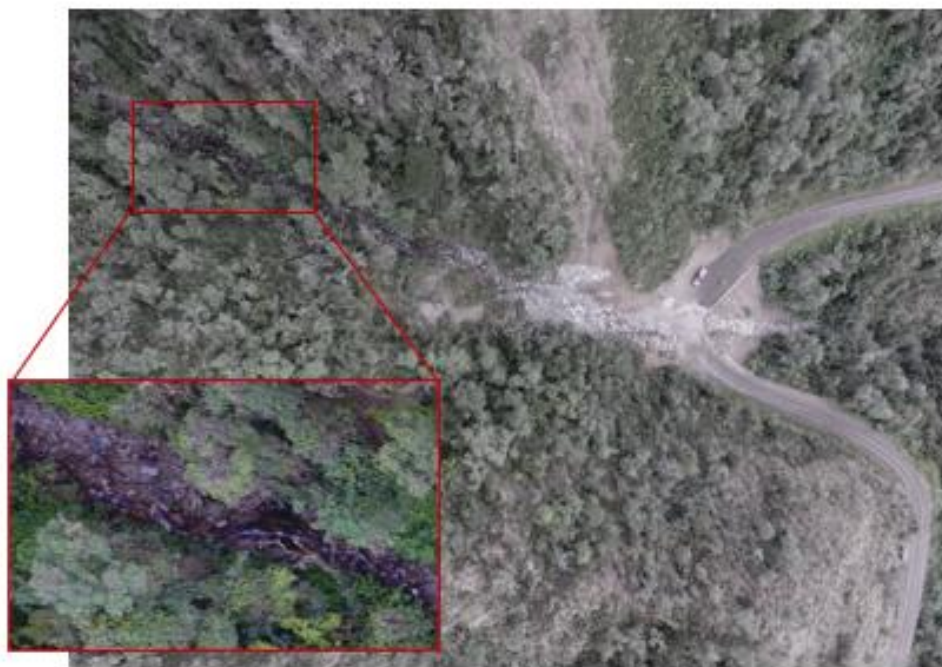
Figura 32. Material acarreado presente aguas arriba de la quebrada Q1. Fuente: Elaboración propia
