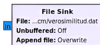
Figura 3.20: Configuración para el bloque File Sink. Fuente: [17]
