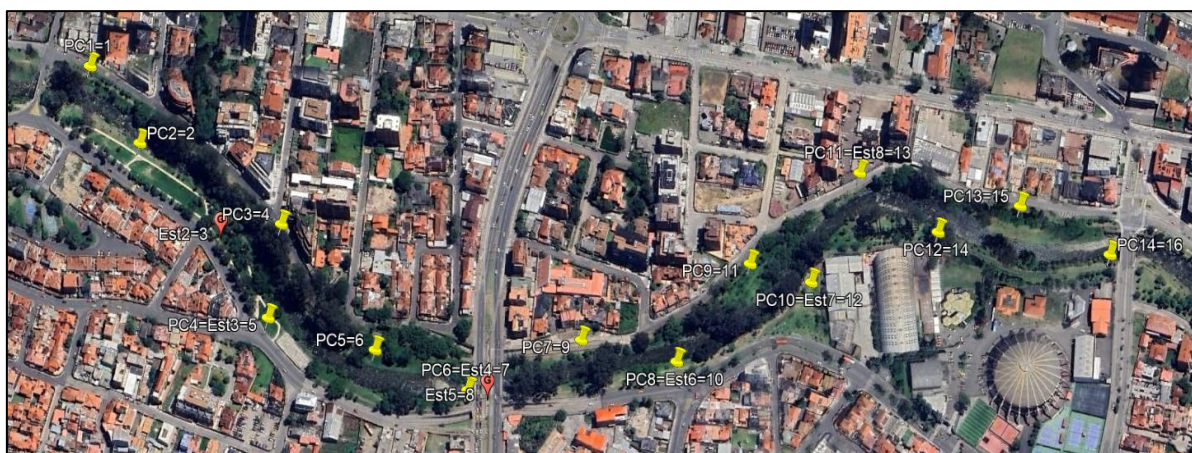
Figura 5. Puntos de control colocados en campo para calibración de modelo fotogramétrico Drone.
