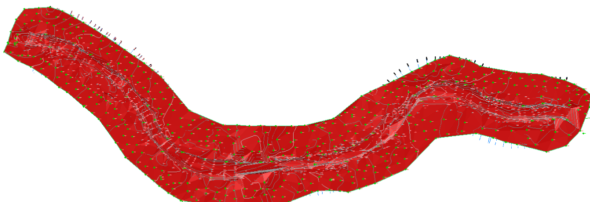
Figura 4. Superficie modelada para levantamiento topográfico en base a datos de Estación Total.
