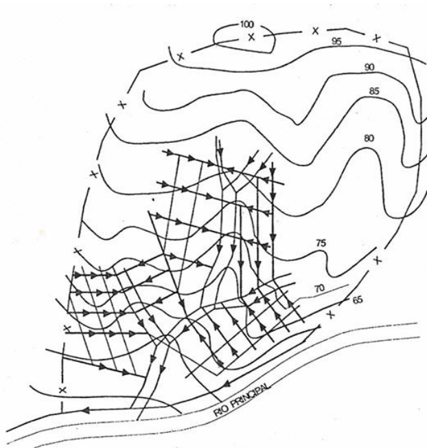
Figura 8. Red de alcantarillado en abanico.
