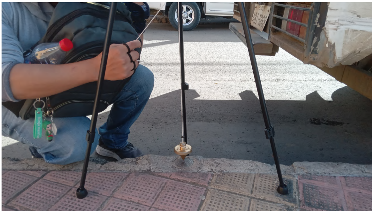
Figura 4.19: Centrado uno de los puntos a evaluar con una plomada.
