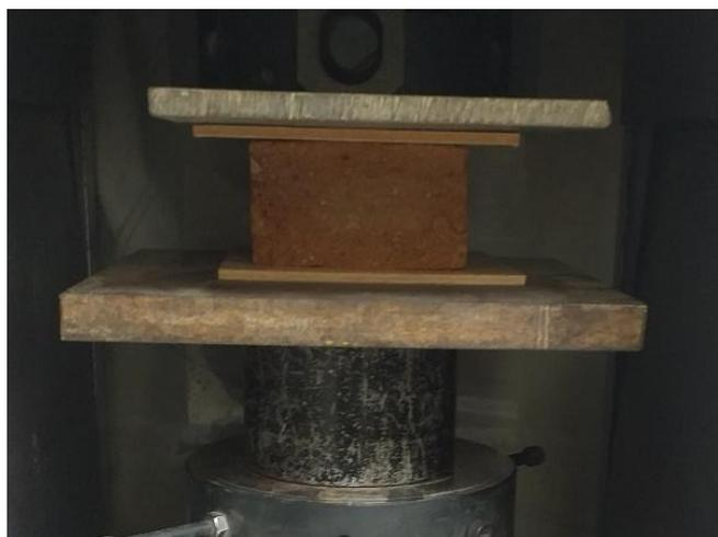
Figura 5 Ensayo a compresión del ladrillo, ubicación del plywood
