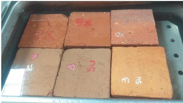
Figura 4 Ensayo de absorción por ebullición
