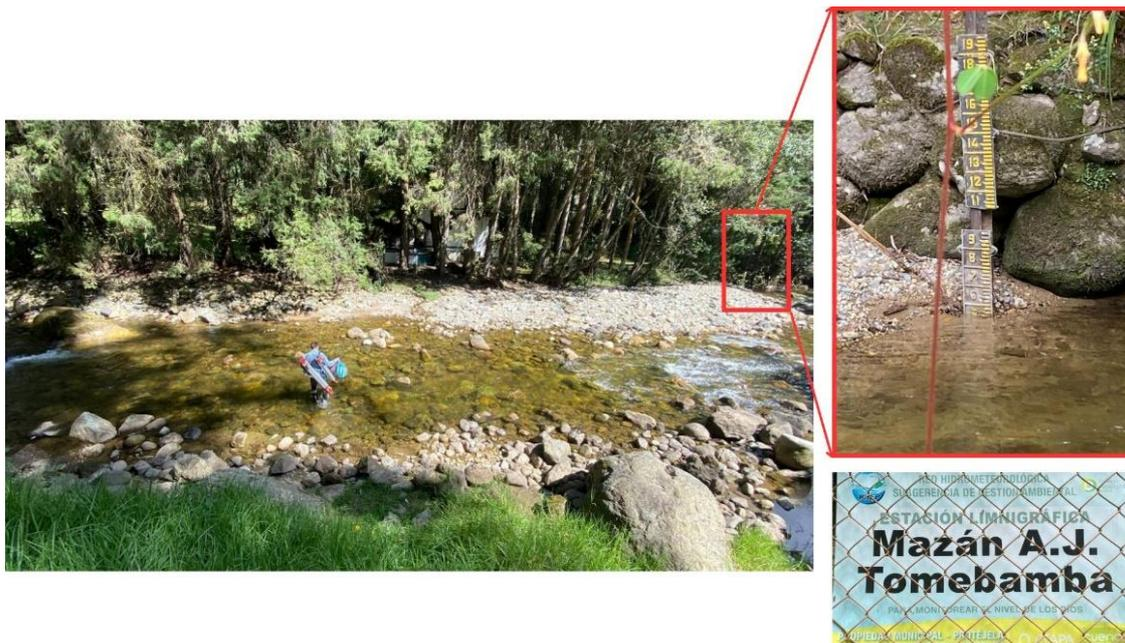
**Figura 4-12.** Tramo de control de la Estación Mazán A.J. Matadero y regleta de medición de nivel de la estación limnigráfica Mazán A.J. Tomebamba de propiedad municipal. Fuente: Elaboración propia.
