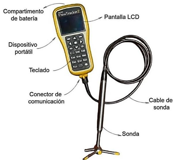
**Figura 2-2.** Componentes del sistema FlowTracker2, dispositivo portátil y sonda.
