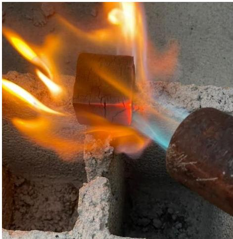
Figura 45 Proceso de ensayo de resistencia al fuego en madera natural
