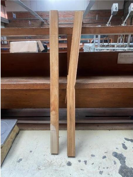
*Figura 58 Muestras de los ensayos de flexión en madera natural*
