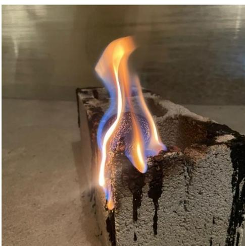
Figura 46 Muestra de madera plástica en ensayo de resistencia al fuego.
