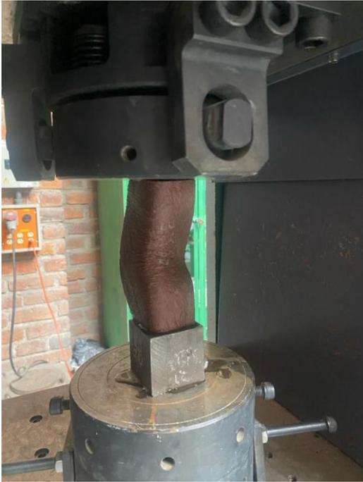
Figura 59 Ensayos de compresión en madera plástica
