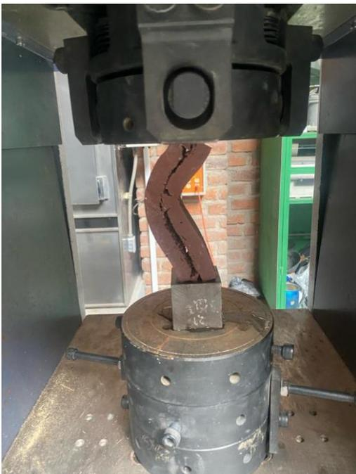
Figura 60 Ensayos de compresión en madera plástica
