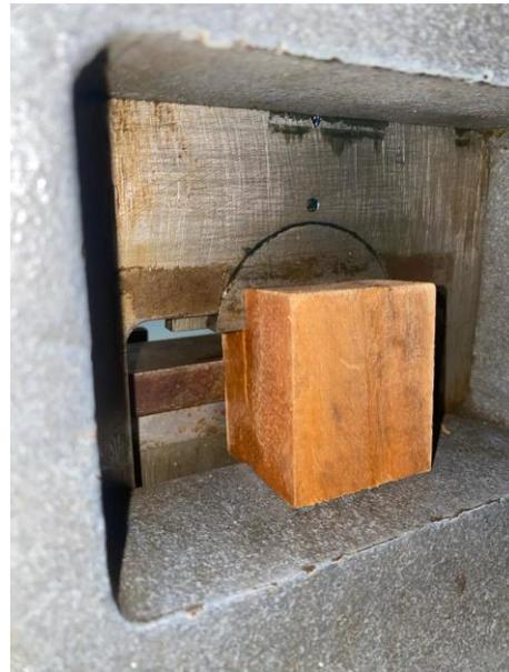
*Figura 42 Madera natural en equipo de ensayo de corte paralelo al grano*
