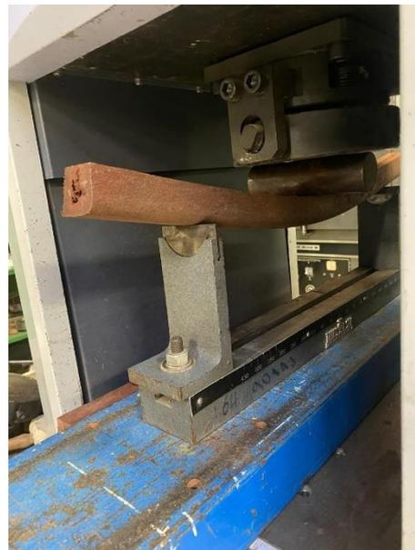
*Figura 57 Ensayos de flexión en madera plástica*
