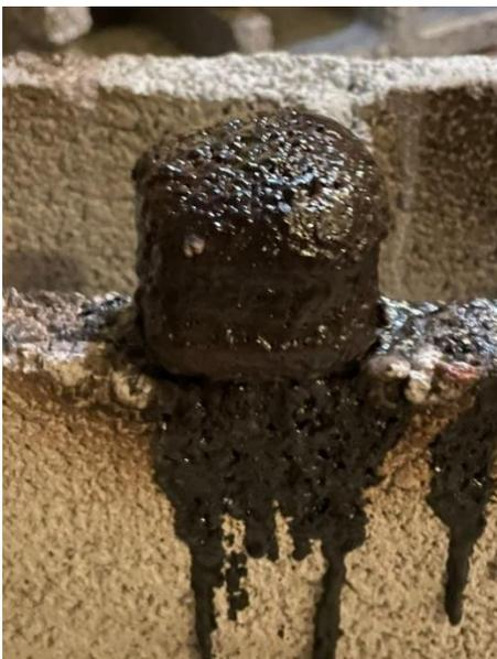
*Figura 71 Resultado de madera plástica, la muestra se sublima.*
