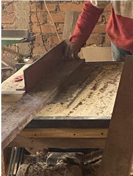
*Figura 21 Proceso de corte de los tablonces de madera plástica.*
