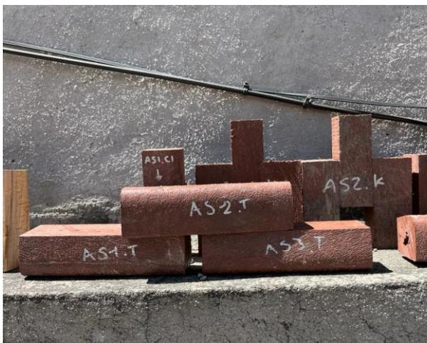
Figura 34 Muestras de madera plástica para el ensayo de compresión paralela a la fibra
