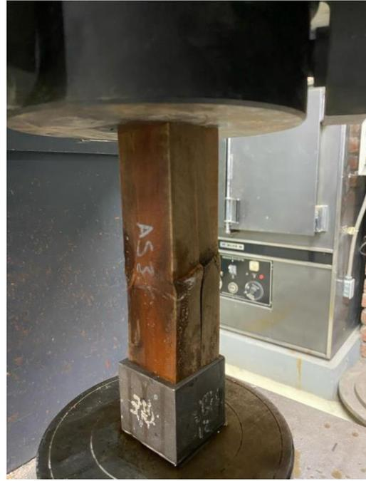
Figura 61 Ensayos de compresión en madera natural
