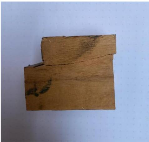
*Figura 49 Muestra de los ensayos de corte en madera natural - Vista lateral*
