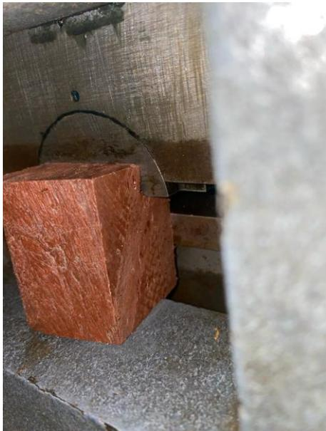
*Figura 41 Madera plástica en equipo de ensayo de corte paralelo al grano*
