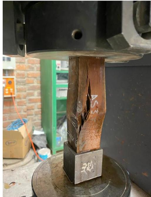
Figura 62 Ensayos de compresión en madera natural
