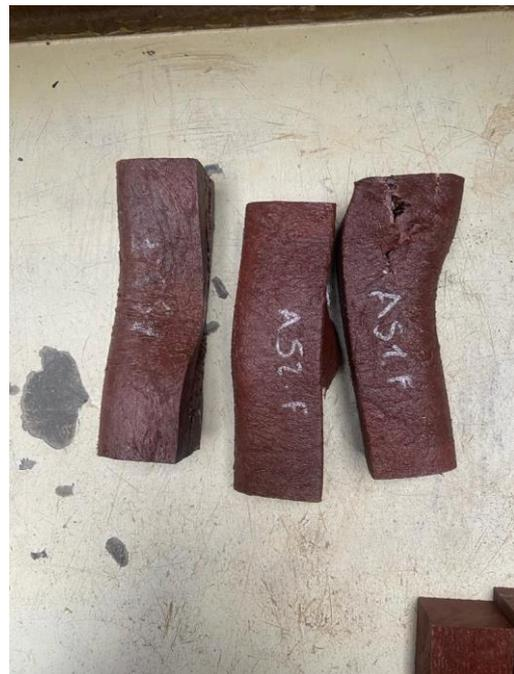
Figura 66 Resultados de ensayos de compresión en madera plástica
