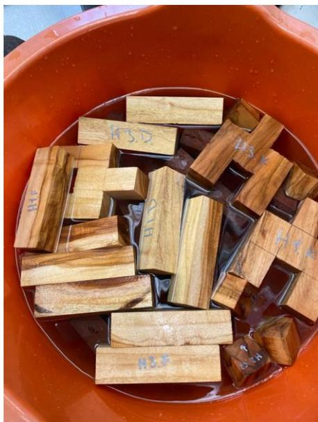
*Figura 24 Muestra de madera natural en condición sumergida el primer día*
