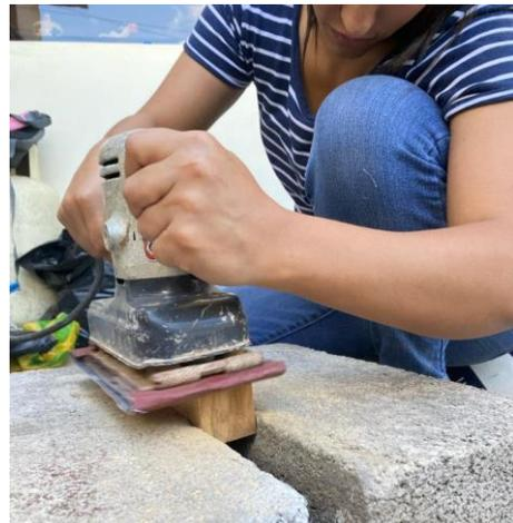
Figura 47 Proceso de ensayo de resistencia a la abrasión
