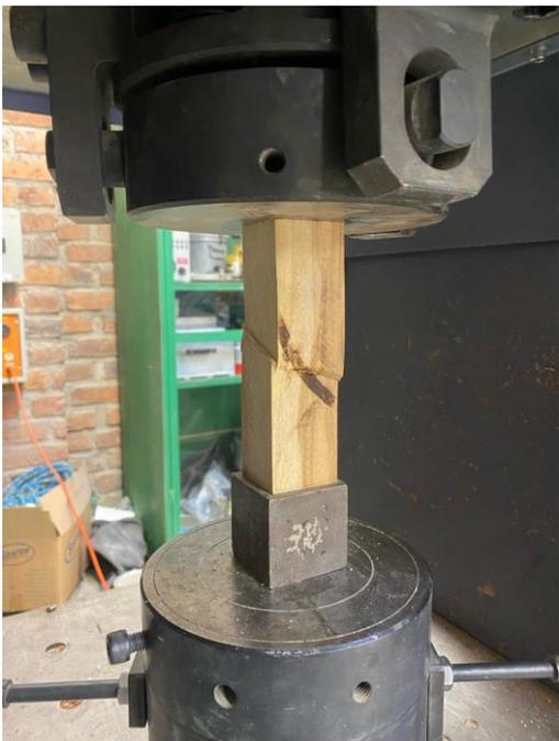
Figura 64 Ensayos de compresión en madera natural
