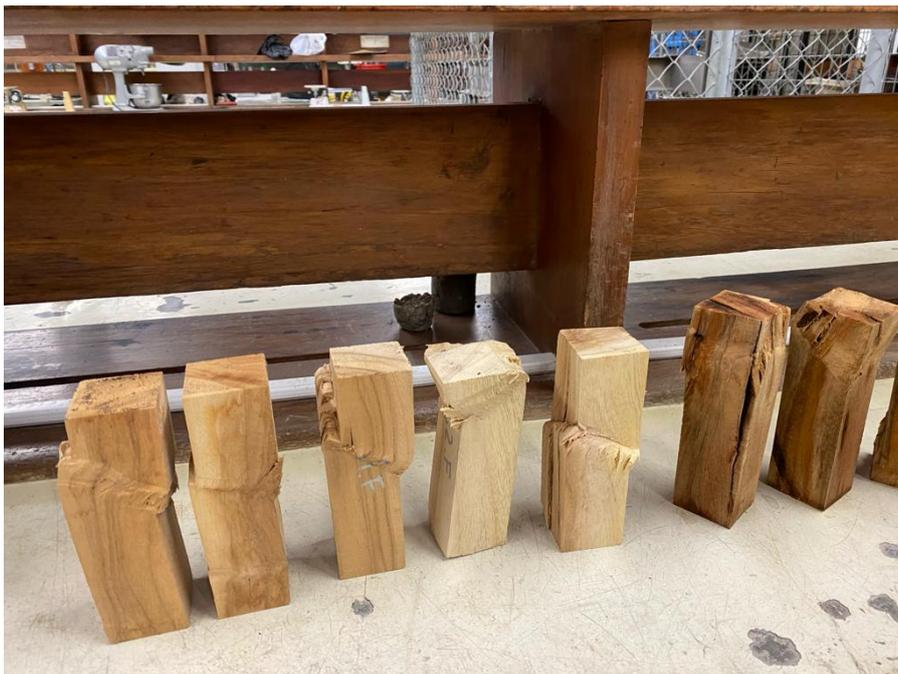
*Figura 68 Resultados de ensayos de compresión en madera natural*
