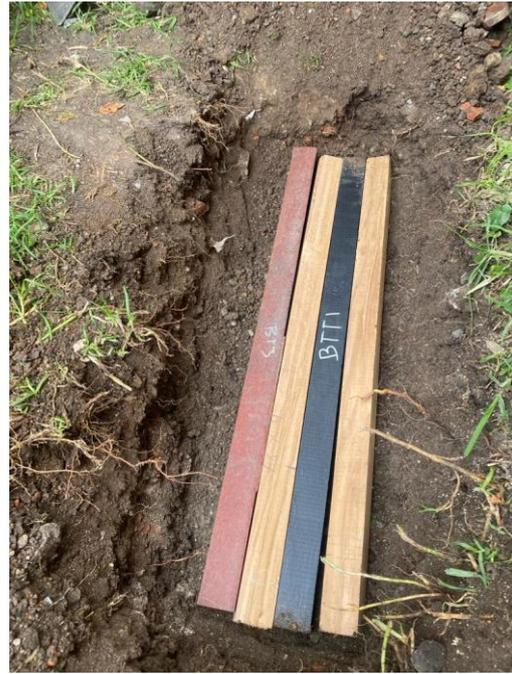
Figura 28 Muestras de madera plástica, natural y natural con tratamiento de cemento acuoso bajo tierra
