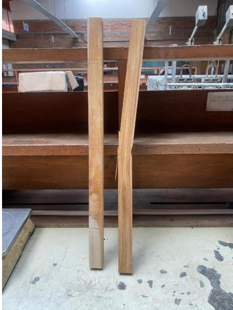
Figura 33 Derecha. Muestra de madera natural para ensayo de flexión estática
