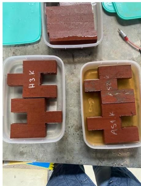
*Figura 26 Comparación de características de la madera plástica sumergida vs. madera plástica con tratamiento sumergida.*
