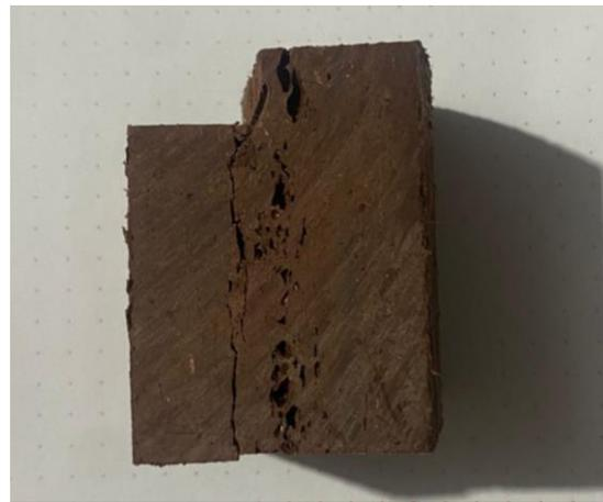
*Figura 51 Muestra de los ensayos de corte en madera plástica - Vista lateral*
