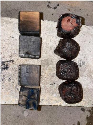
*Figura 70 Resultados de resistencia al fuego de madera natural (izquierda) y madera plástica (derecha)*
