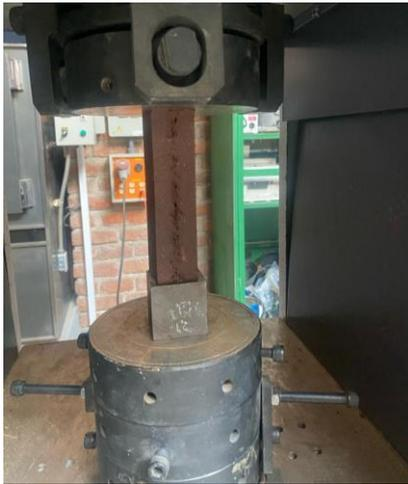
Figura 43 Madera plástica en equipo de ensayo de compresión paralelo a la fibra
