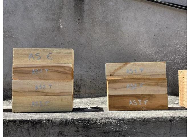
Figura 35 Muestras de madera natural para el ensayo de compresión paralela a la fibra
