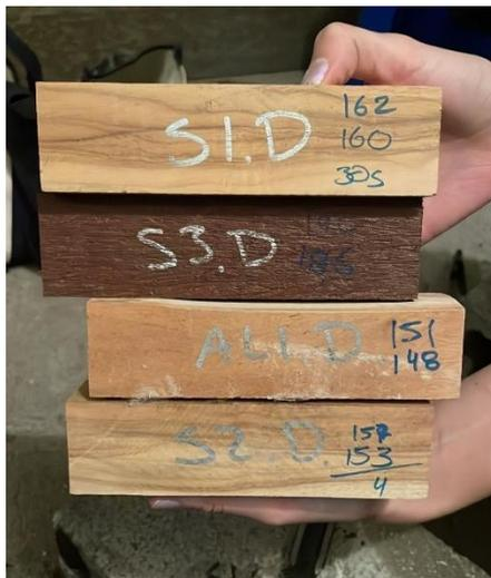
Figura 39 Muestras de madera natural y plástica para el ensayo de resistencia a la abrasión.
