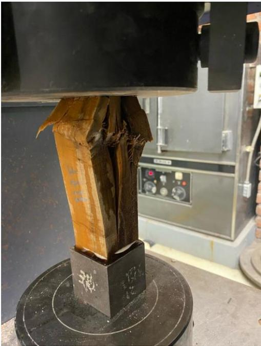
Figura 63 Ensayos de compresión en madera natural
