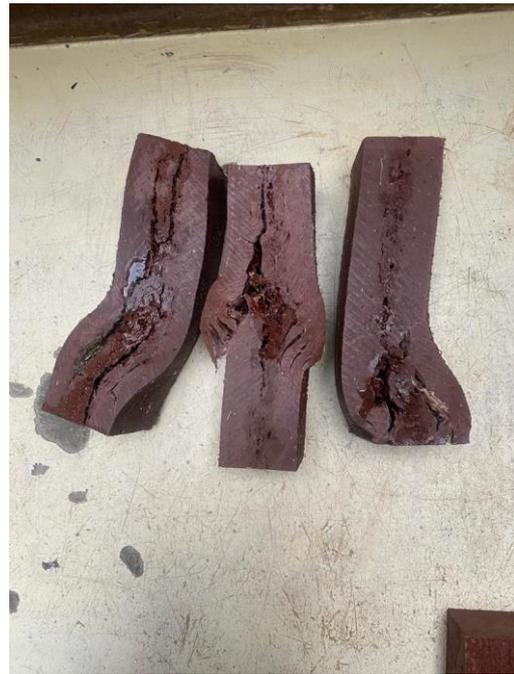
Figura 65 Resultados de ensayos de compresión en madera plástica
