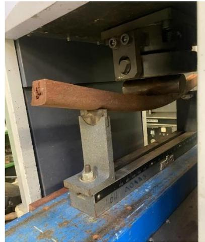
Figura 44 Madera plástica en equipo de ensayo de flexión está
