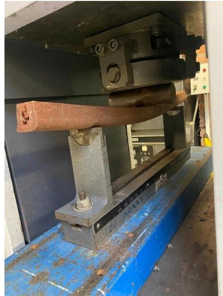
*Figura 56 Ensayos de flexión en madera plástica*
