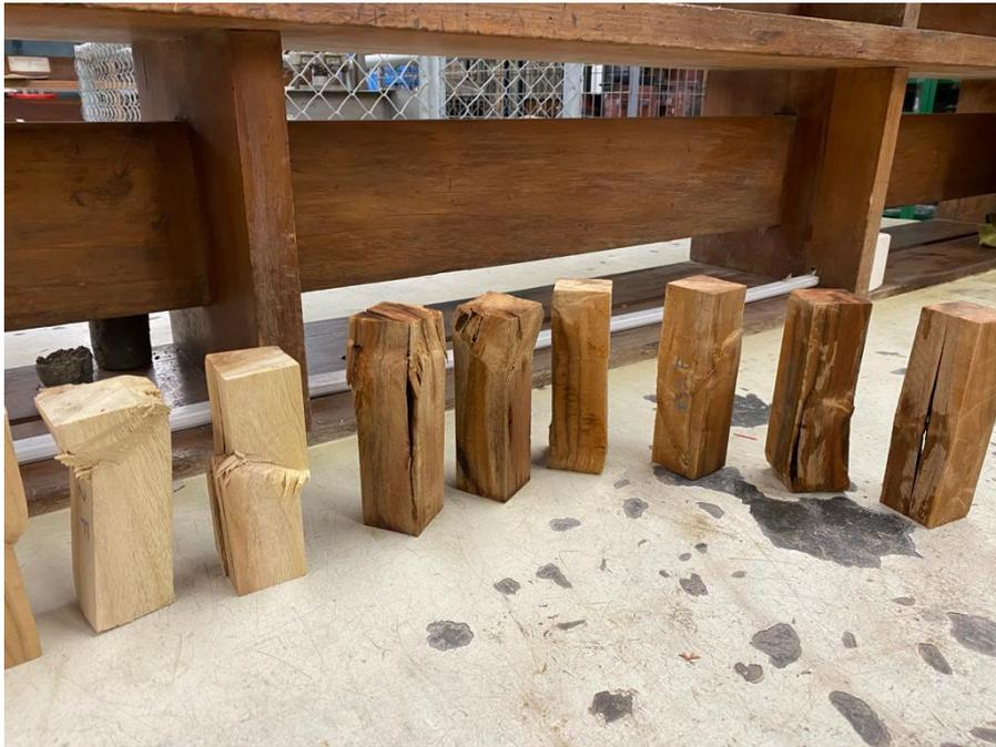
*Figura 67 Resultados de ensayos de compresión en madera natural*
