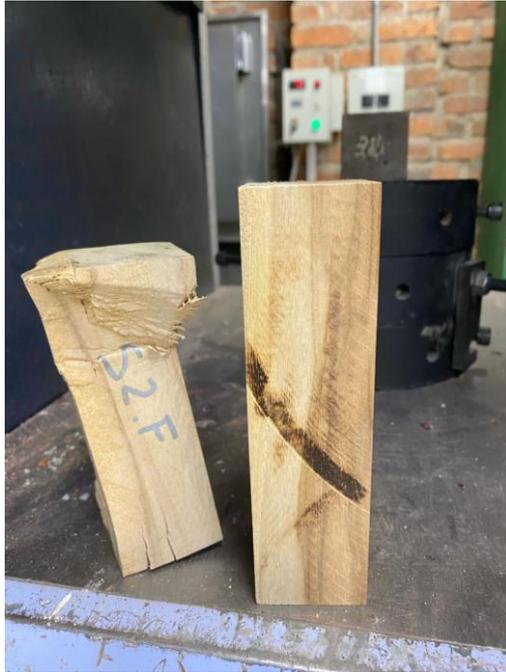
*Figura 69 Muestra ensayada (derecha) y sin ensayar (izquierda) a compresión de madera natural*
