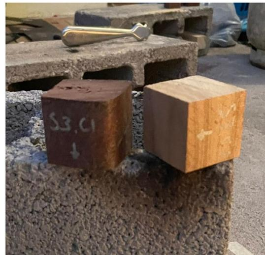
Figura 40 Muestras de madera natural y plástica para el ensayo de resistencia al fuego
