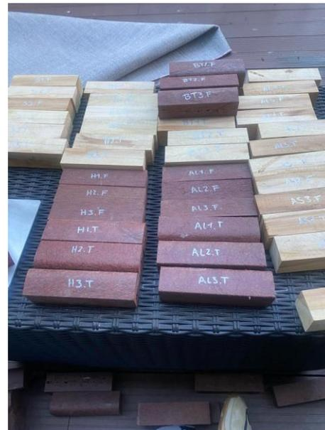
Figura 36 Muestras de madera natural y plástica para el ensayo de compresión paralela a la fibra
