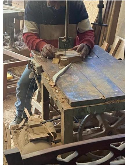
*Figura 22 Proceso de corte de muestras de madera natural.*
