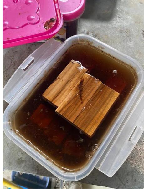
*Figura 25 Muestra de madera natural en condición sumergida el día de ensayo*
