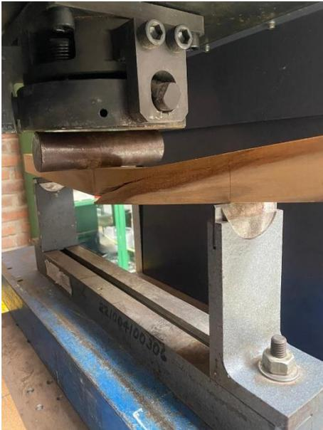
*Figura 54 Ensayos de flexión en madera natural*
