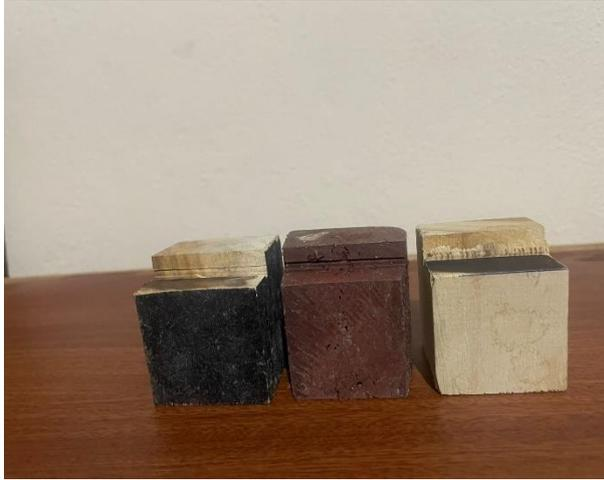
Figura 37 Muestras de madera natural y plástica para los ensayos de corte paralelo al grano - Vista Frontal
