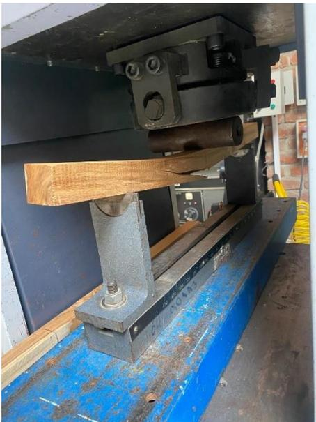
*Figura 55 Ensayos de flexión en madera natural*
