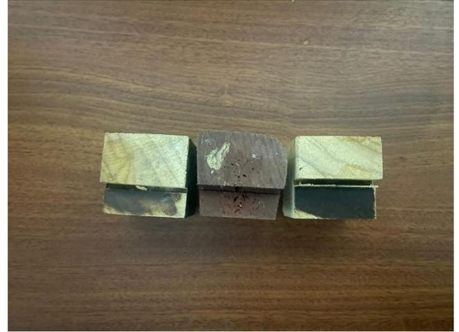
Figura 38 Muestras de madera natural y plástica para los ensayos de corte paralelo al grano – Vista Planta
