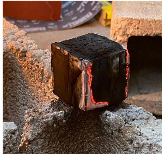
*Figura 72 Resultado de madera natural, la muestra en carbonización.*
