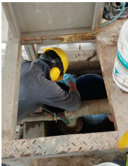
Figura 10. Toma de agua para el cálculo de caudal por medio del método de aforo volumétrico.
