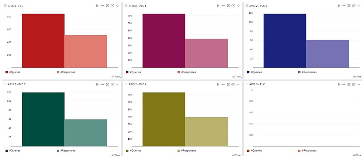
Figura 4.3: Datos recolectados de los PLC, posterior a la desconexión de un equipo
