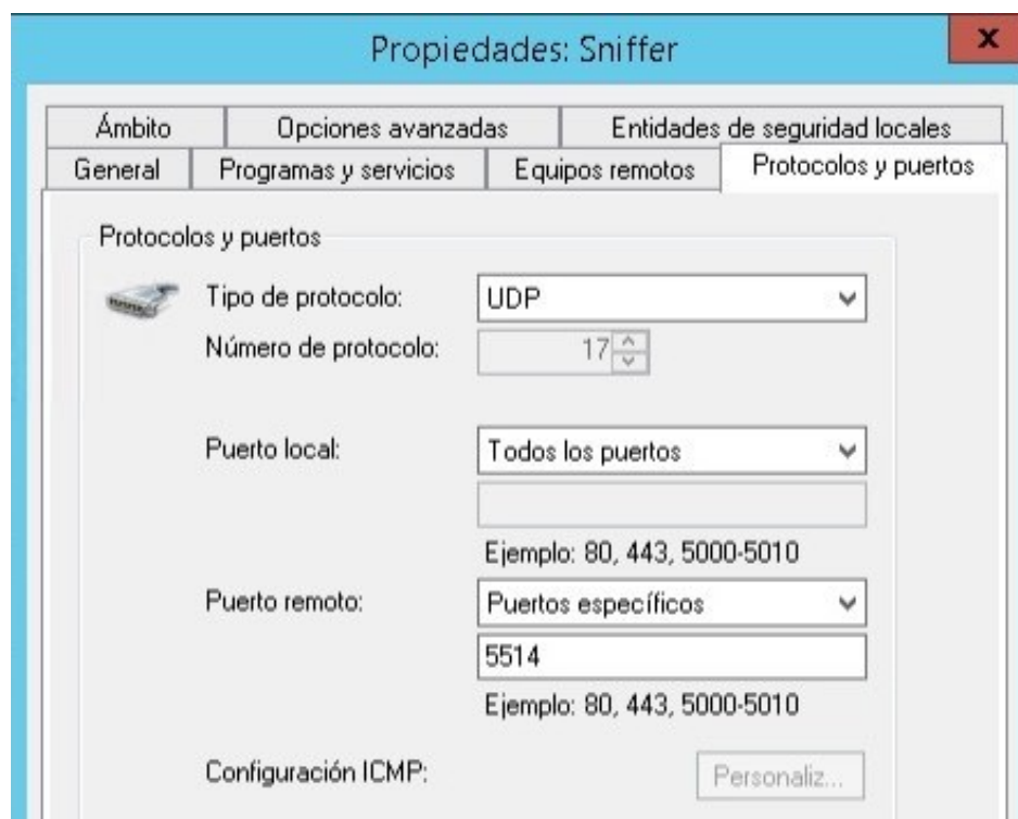
Figura 3.9: Regla de salida habilitada para el puerto 5514
