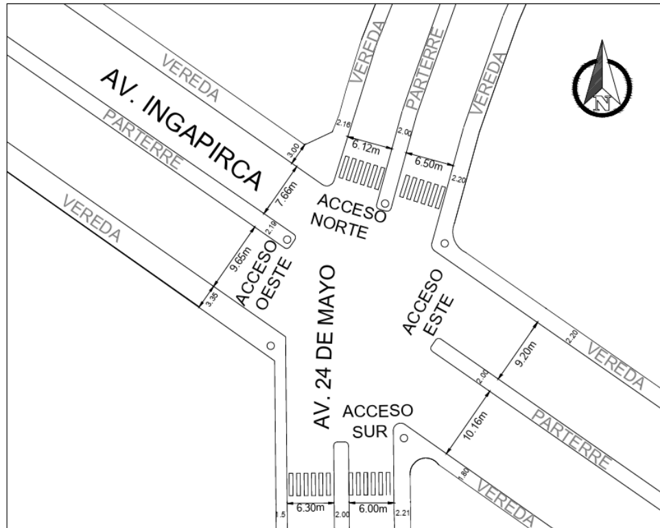
Ilustración 3. Geometría de los accesos de la estación 1
