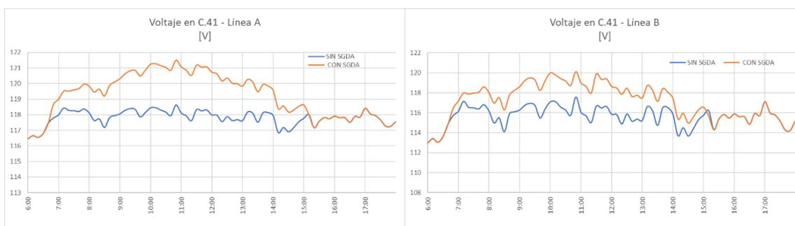
**Figura 4.33:** Voltaje en el usuario C.41 antes y después de la incorporación del SGDA. Fuente: Propia.
