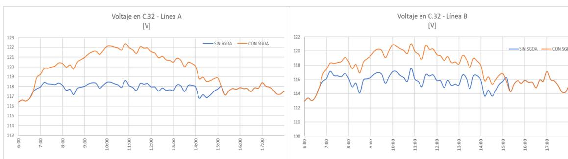
**Figura 4.32:** Voltaje en el usuario C.32 antes y después de la incorporación del SGDA. Fuente: Propia.
