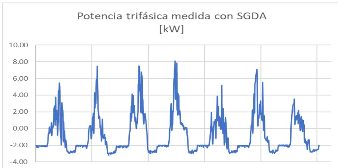
**Figura 4.65:** Potencia trifásica medida con SGDA. Fuente: Propia.
