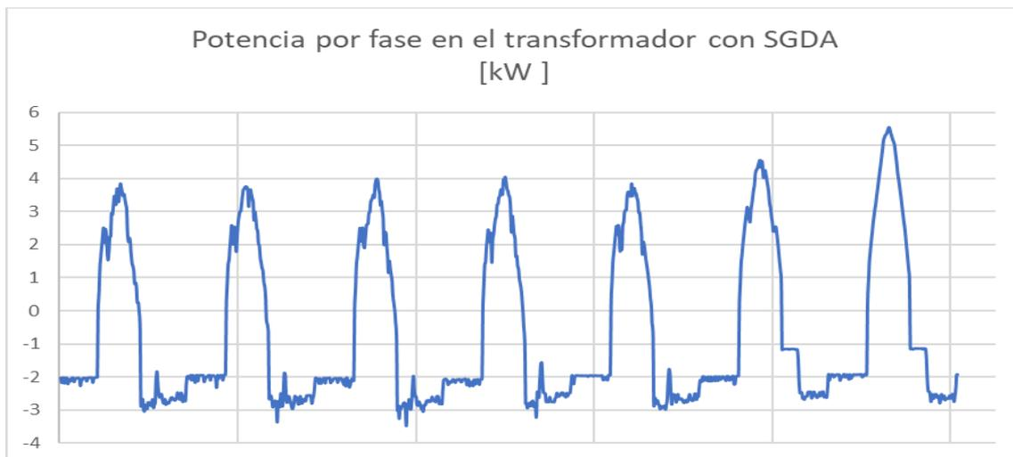
**Figura 4.63:** Potencia trifásica con SGDA. Fuente: Propia.
