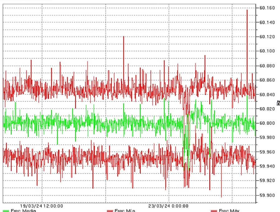
**Figura 3.29:** Variación de frecuencia con SGDA. Fuente: Propia.
