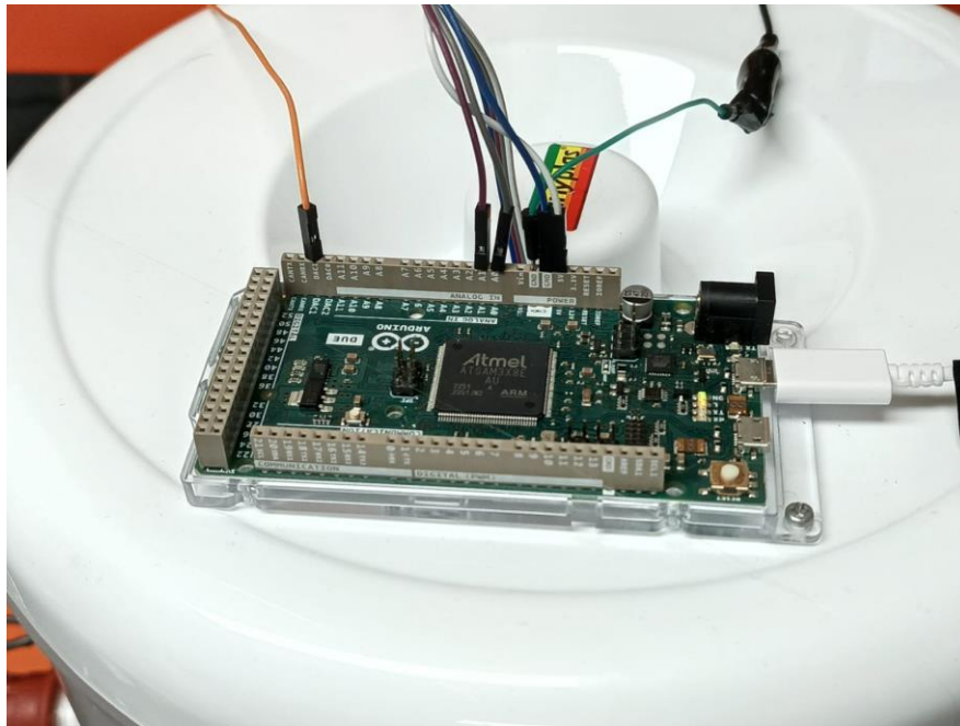
Figura H.3. Colocación e instalación del Arduino DUE en la parte superior de la tapa. Fuente: Los autores.
