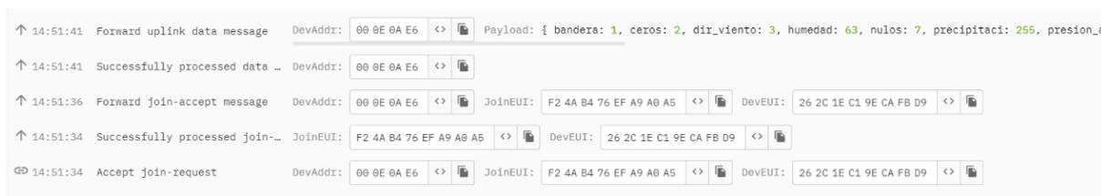
Figura 4.5: Proceso de inicialización en el servidor LoRaWAN
