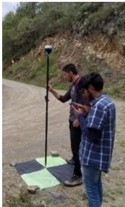
Figura 13 Georreferenciación de los puntos de apoyo y control.
