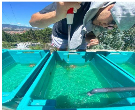
Figura 4.6 Siembra de microalgas en el diseño experimental con volumen de 20 litros de agua residual.
