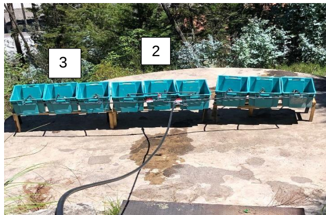
Figura 4.3 Gavetas de tratamiento para biorremediación (bloques 1;2;3)
