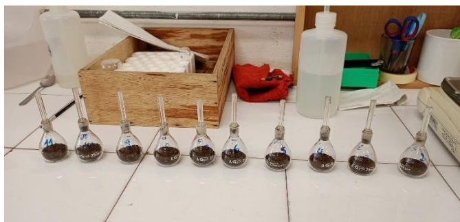
Figura 7. Método del picnómetro para determinación de densidad real
