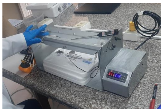
Anexo G. Preparación del dispositivo de calentamiento (STC-3008).
