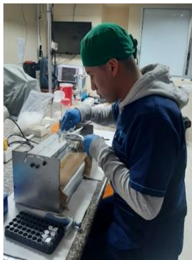
Anexo H. Calentamiento de Pellets en el dispositivo (STC-3008).
