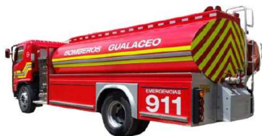
Figura 12. Vehículo cisterna o tanquero
