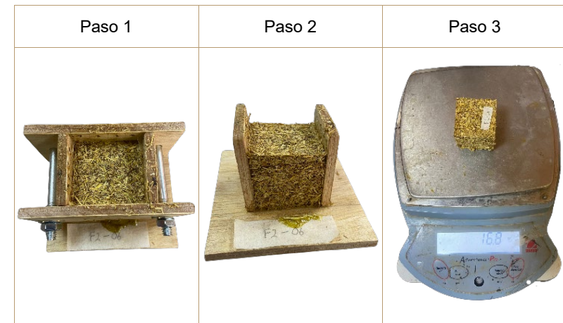
Figura 35. Proceso de desencofrado de prototipo de fibra de totora. Fuente: Elaboración propia (2024)
