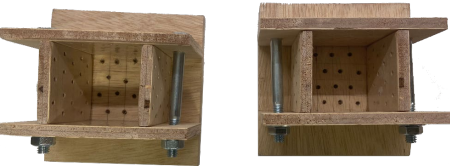
Figura 23. Moldes con papel Contac en el interior. Fuente: Elaboración propia (2024)
