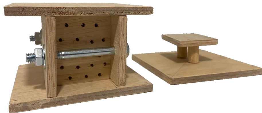
Figura 24. Molde final de madera triplex. Fuente: Elaboración propia (2024)
