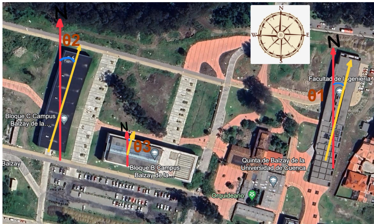
Figura 3.10: Orientación de los paneles solares. Fuente: [propia]
