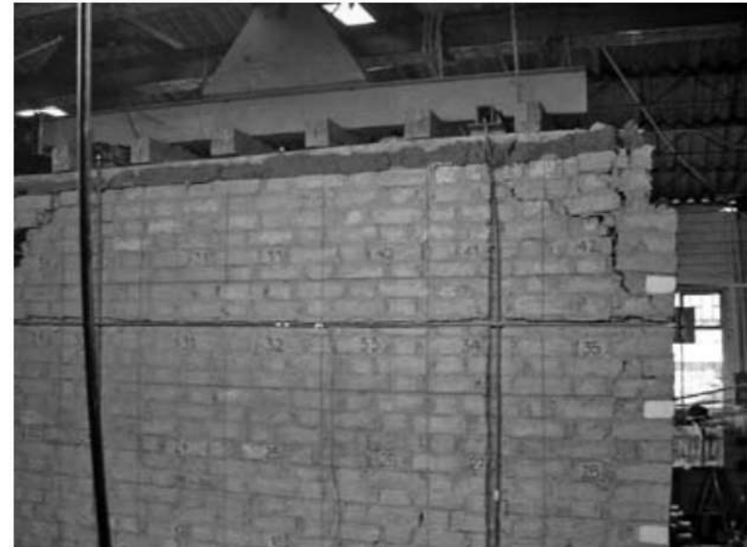
Figura 68: Ensayo de muros con tensores de acero.
