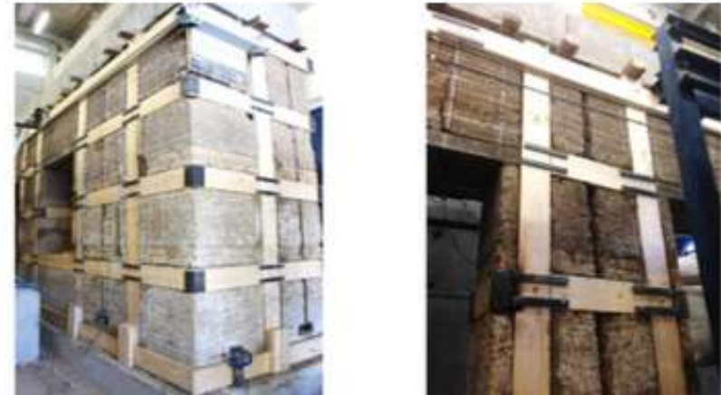
Figura 63: Sistema de maderas de confinamiento.
