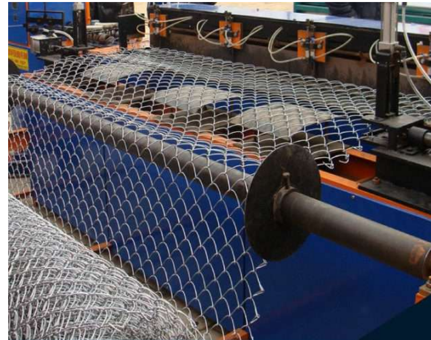
Figura 56: Elaboración de mallas metálicas.
