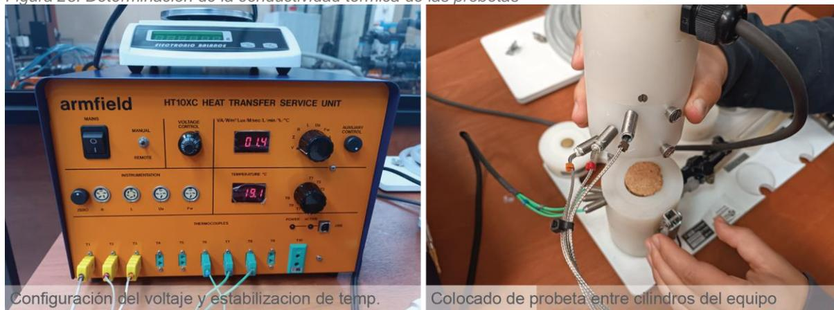
Configuración del voltaje y estabilización de temp.
