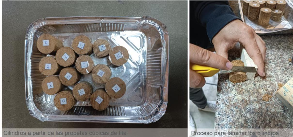
Cilindros a partir de las probetas cúbicas de tifa
